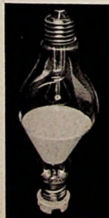
Bild 4. 4-W-Lautsprecher mit eingeklebter Hochtonegelmembrane
